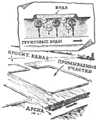
Пресная вода, заполняя промываемые участки поля, растворяет вредные соли и профильтровывается в подпочвенные горизонты или отводится в специальные выводящие каналы (дрены, коллекторы).
